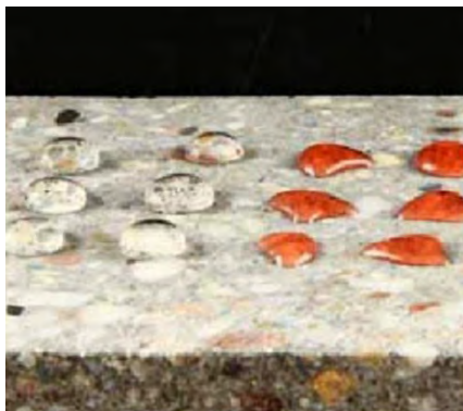
Pav. 1 paviršius, apdorotas impregnantu Mapecrete Stain Protection
